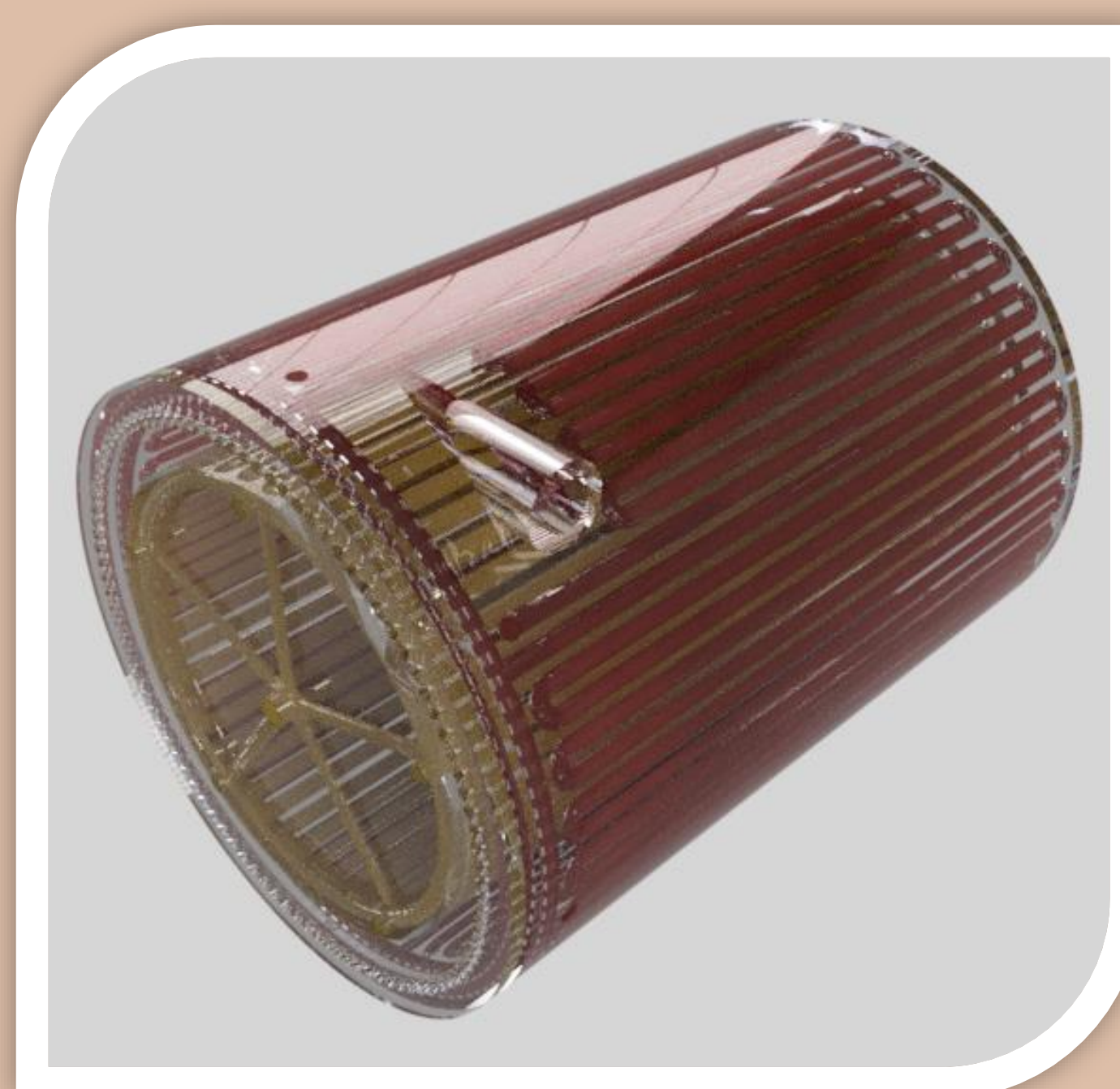
Fig. 3. Rendering som illustrerer kølekanals-konfigurationen. Forbrændingskammerets vægge er gennemsigtige. Kølekanalerne i den inderste væg er farvet gule, og kølekanalerne i den yderste væg er farvet røde.
